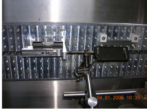
Figura 77: Fotografia del sistema per mesurar les deformacions longitudinals de la biga fixa.
