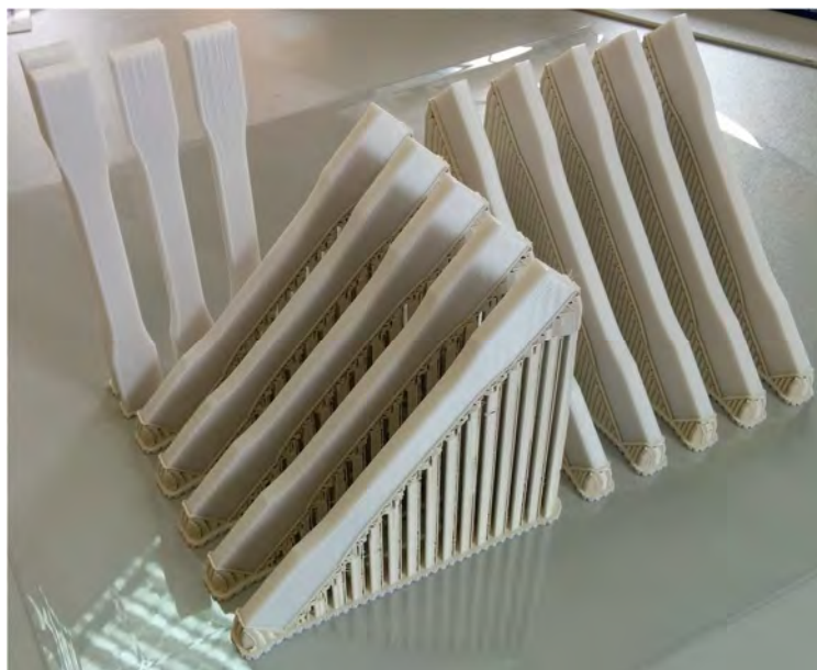
Figura 3.13: Probetas de tensión/elongación fabricadas en las orientaciones 3, 5 y 6 (Figura 3.10).
