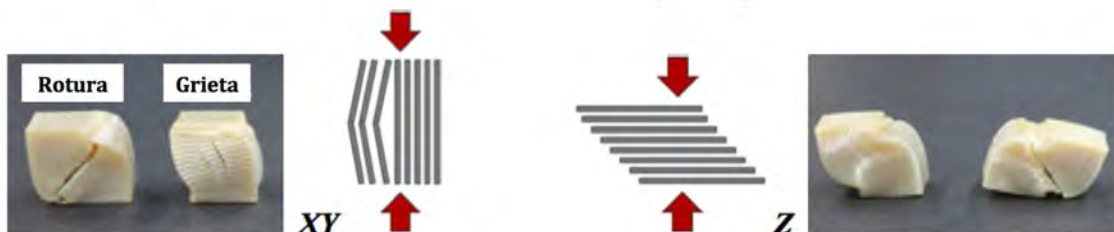
Figura 3.7: Esquema de la aplicación de la carga en probetas de compresión y fotos de las grietas 28 .
