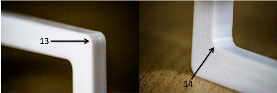
Figura 6.13: Detalle del acabado superficial de las superficies 13 (izquierda) y 14 (derecha) de la pieza ejemplo para la orientación 2.
