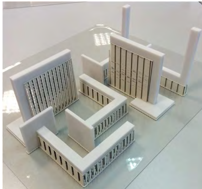
Figura 3.19: Probetas fabricada mediante FDM.
