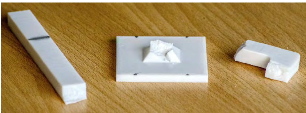
Figura 6.29: Probeta 5.02 rota después del ensayo.
