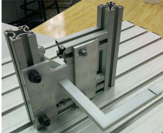
Figura 3.20: Montaje de sujeción de las piezas para la experimentación física, con la posición de aplicación de la fuerza marcada.
