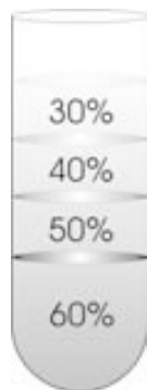
Figura 9.1: Esquema del gradiente de sacarosa. En este esquema se muestra las diferentes fases del gradiente escalonado. Una vez centrifugada la muestra, los cromosomas quedaban concentrados en las interfases 40-50 % y 50-60 % (p/v).
