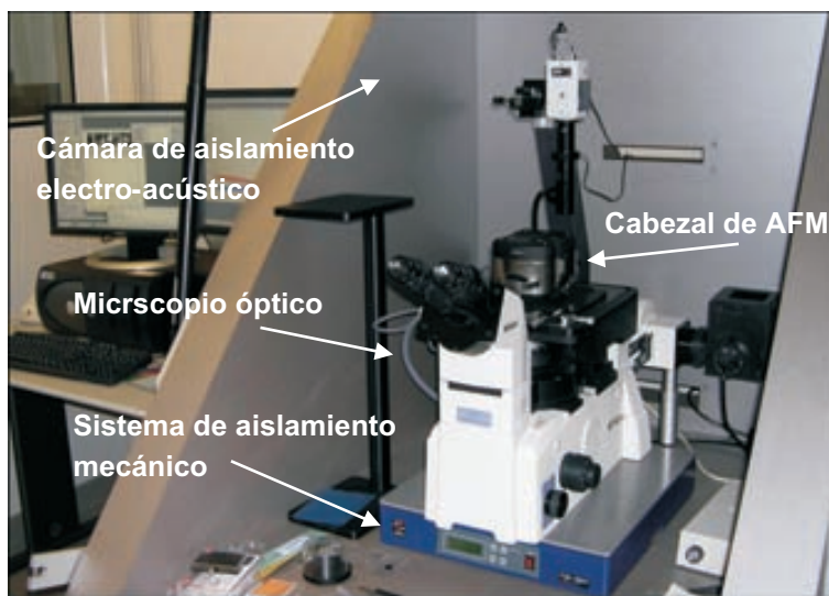
Figura 11.1: Equipo AFM MFP 3D-BIO utilizado en esta tesis. Este AFM está integrado en un microscopio óptico Nikon. El conjunto está dispuesto en una cámara de protección electro-acústica y aislado de las vibraciones mecánicas del suelo.
