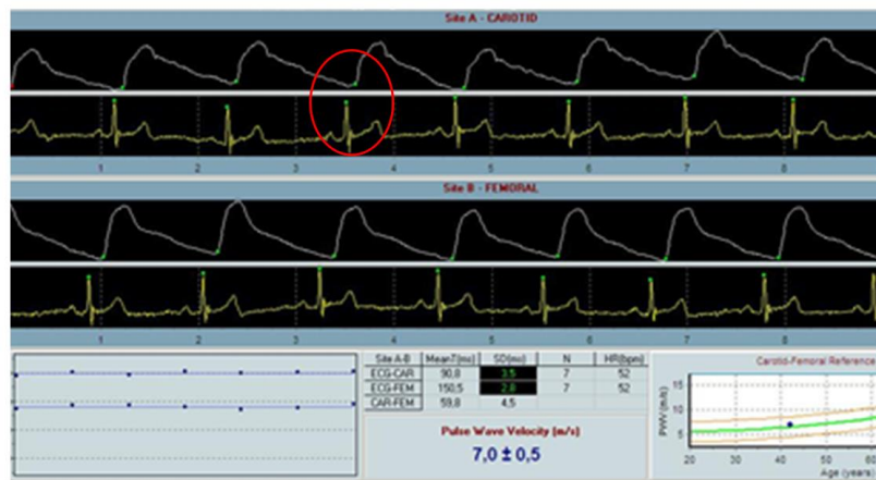
Figura 44. Ejemplo del cálculo del tiempo con el sistema Sphygmocor usando un registro ECG simultáneo, tanto en arteria carótida (A, arriba) primero como en femoral (B, abajo) después. Paciente de la tesis.
