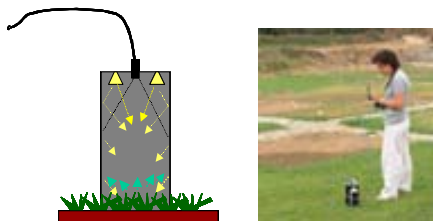
Figura 2.10 Esquema del capçal usat en les mesures espectroradiomètriques, les fletxes descendents indiquen la llum emesa per les làmpades halògenes (irradiància) i les ascendents, la reflectada per la vegetació (radiància). La fibra òptica capta el conjunt de les dues (reflectància). Mesures a la dreta (esquema i foto J. Casadesús).
