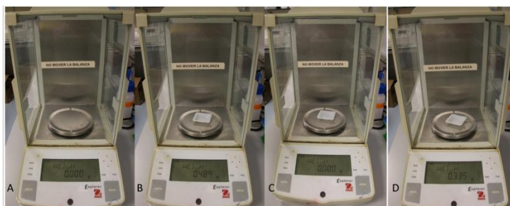
Figura 6. Procedimiento pesado de muestras: A) báscula de precisión; B) bandeja para muestra; C) descontar el peso; D) muestra y peso.
