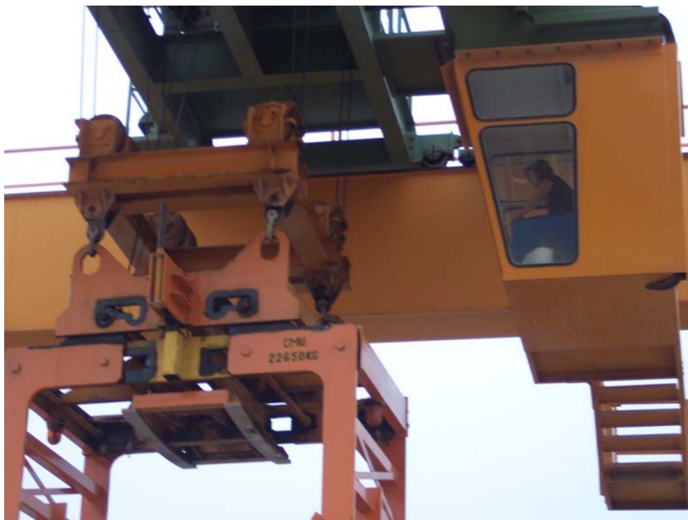
Figuras 59.- Fase de acopio: manejo del puente grúa.
