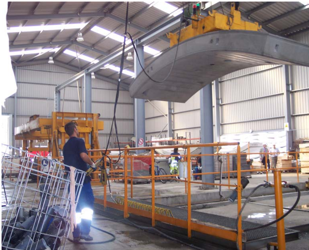
Figuras 45.- Fase de extracción de la dovela: izado y transporte a la grúa volteadora.
