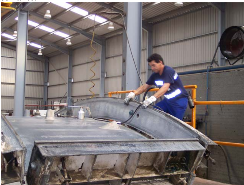
Figuras 15.- Fase de limpieza del molde: carga y preparación de la proyección del desencofrante.
