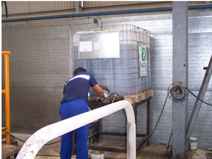
Figuras 14.- Fase de limpieza del molde: carga y preparación de la proyección del desencofrante.
