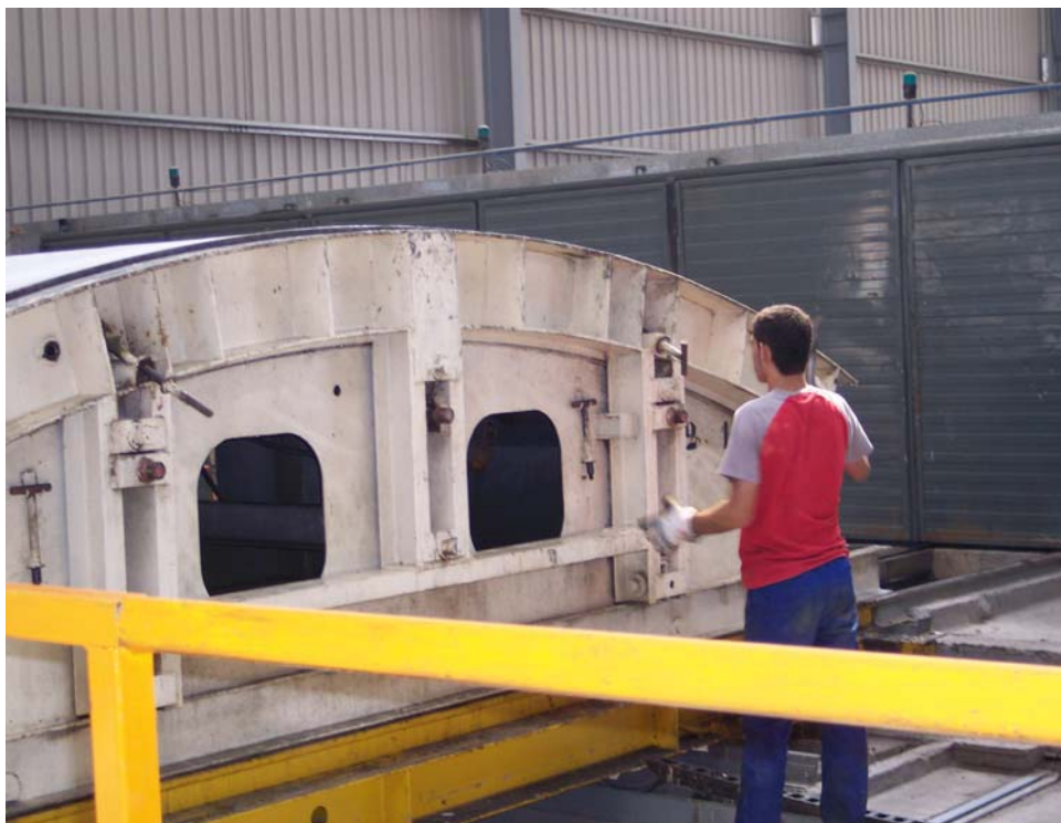
Figuras 10.- Fase de desencofrado: trabajos en el transbordador
