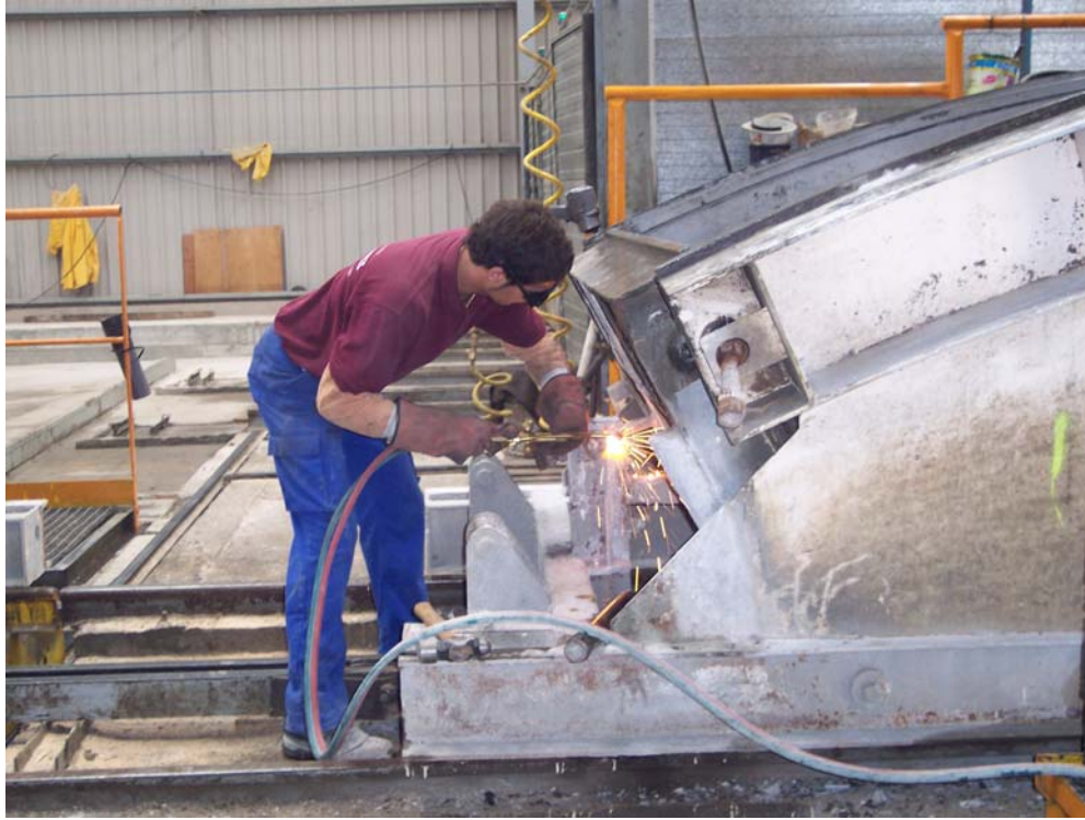
Figuras 73.- Trabajos de mantenimiento: oxicorte.
