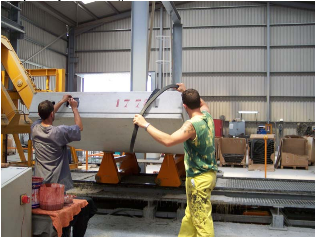
Figuras 49.- Fase de pintado y de colocación de juntas de estanqueidad y gomas: pintado y encolado de gomas.
