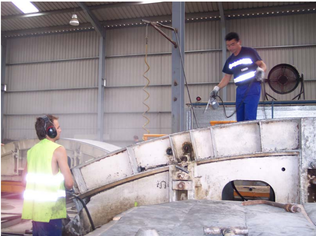
Figuras 19.- Fase de limpieza del molde: proyección del desencofrante y cierre del mismo simultáneamente.
