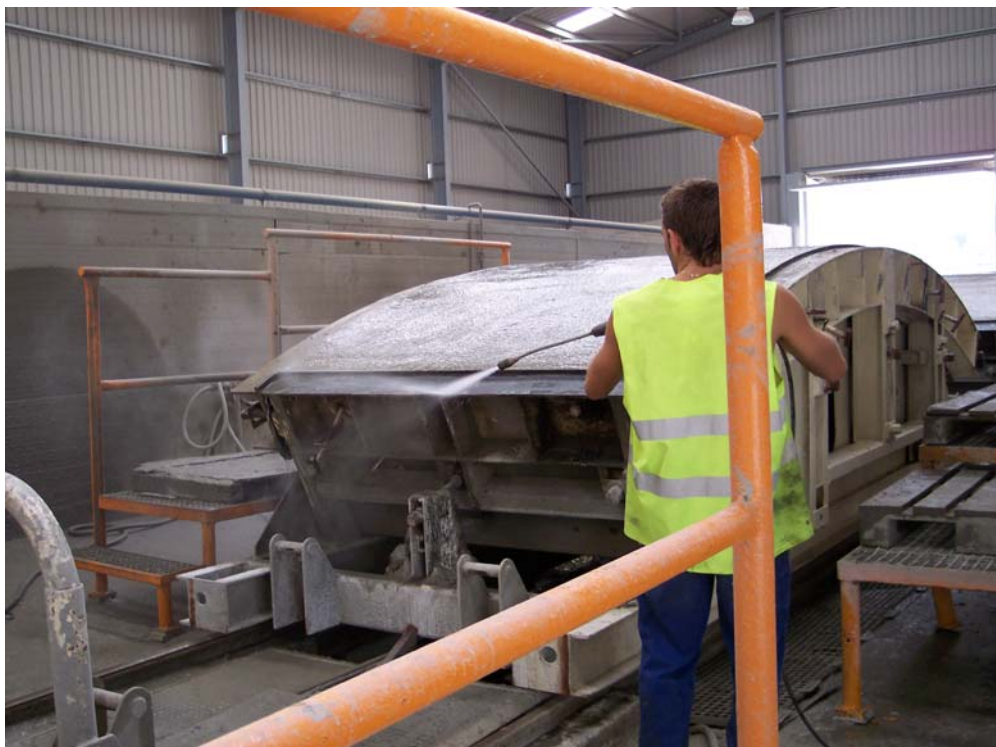
Figuras 38.- Fase de fratasado, alisado y limpieza: limpieza.
