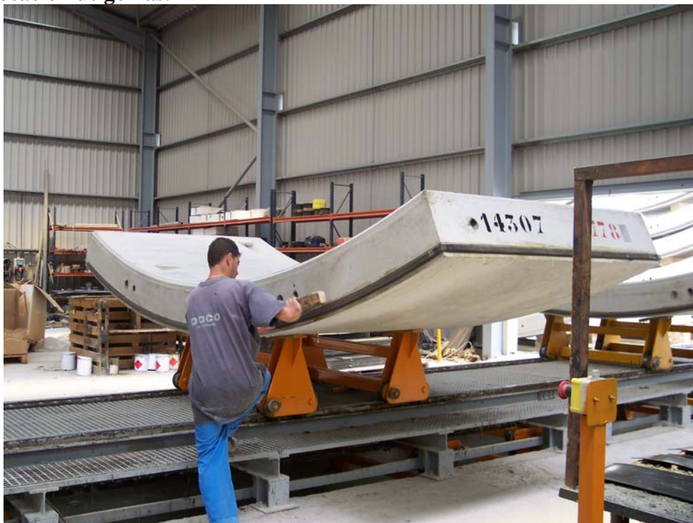
Figuras 51.- Fase de pintado y colocación de juntas de estanqueidad y gomas: colocación de gomas.
