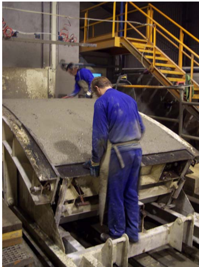
Figuras 42.- Fase de fratasado, alisado y limpieza: fratasado y alisado.
