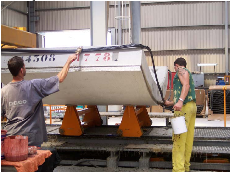
Figuras 50.- Fase de pintado y colocación de juntas de estanqueidad y gomas: colocación de gomas.
