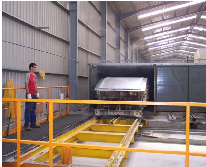
Figuras 8.- Fase de desencofrado: trabajos en el transbordador
