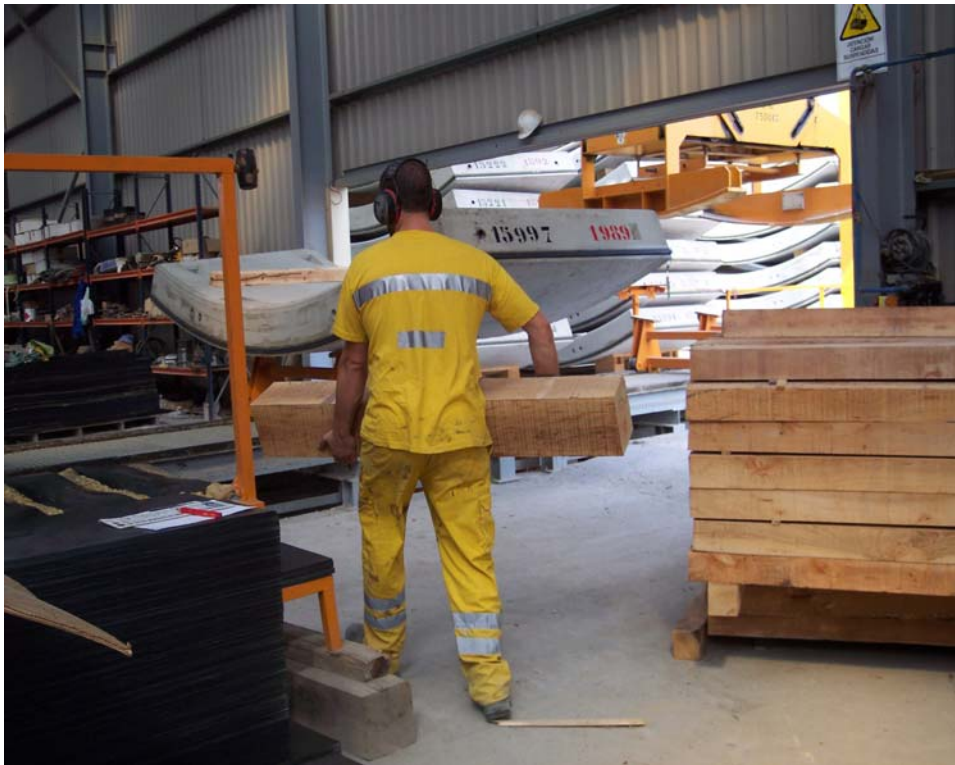
Figuras 54.- Fase de pintado y de colocación de juntas de estanqueidad y gomas: colocación de tablones de madera.
