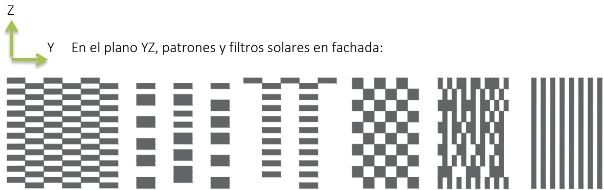
Figura 39 Esquema de filtros solares en fachada, diferentes grados de opacidad. Fuente: elaboración propia
