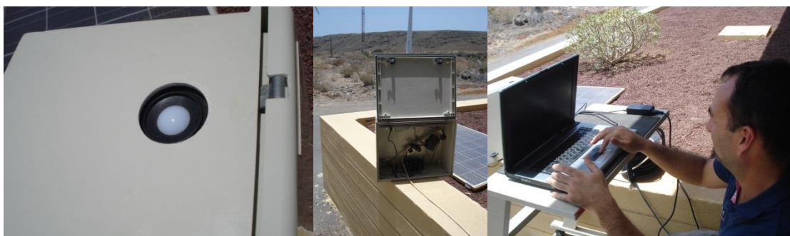
Imagen 29 Fotografías de la adaptación, registro de datos a través del software HOBOWare del luxómetro HT307
