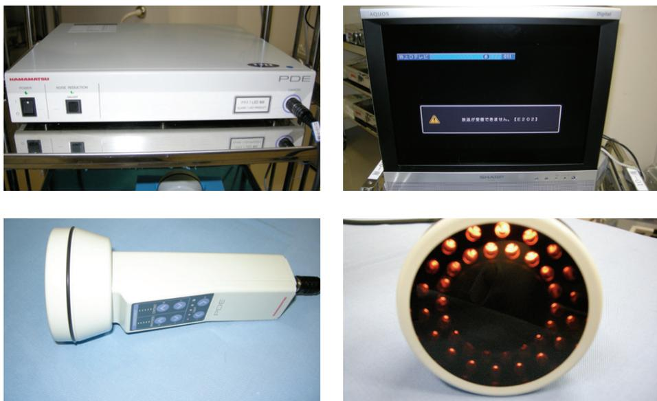
**Figura 14:** Imagen del dispositivo de ICG-L formado por la cámara de infrarrojos y el monitor que permite visualizar las imágenes fluorescentes (PDE - Photodynamic Eye).
