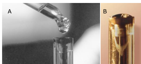
Figura 3.3. (A) Deposició de la membrana de PVC gota a gota; (B) Gota de còctel sensor dipositada que es deixa evaporar fins a l'evaporació del THF.
