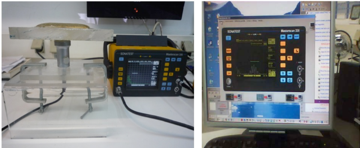
Figura 5. Disposición del sistema de medición por ultrasonidos
