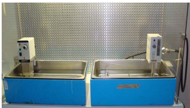
Fig 21. Tanques de agua caliente y agua fría.
