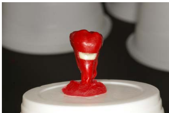
Fig 24. Especímenes con el margen gingival de la obturación expuesto.
