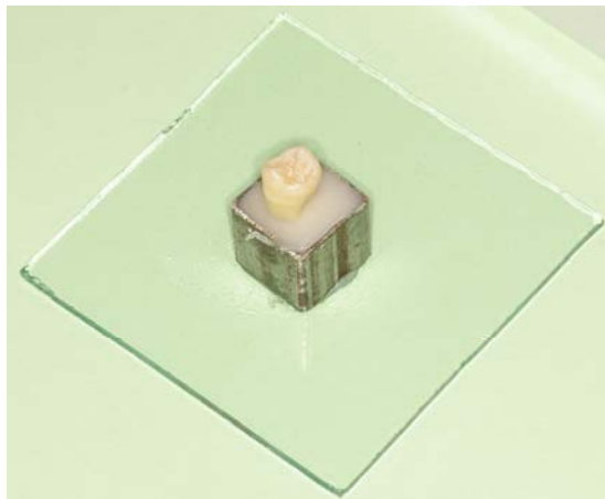
Fig 27. Dientes sembrados en cubos de acrílico, para facilitar su manipulación.
