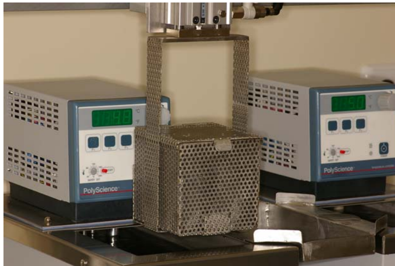
Fig 23. Máquina de termociclado donde se ejecutaron 10.000 ciclos.
