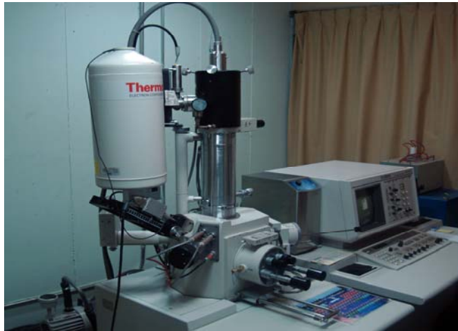
Fig 30. Microscopio electrónico de barrido Hitachi SA- 4000.
