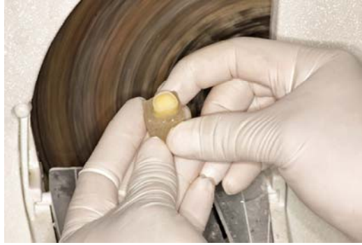
Fig 9. Eliminación del esmalte oclusal en la recortadora de modelo Drillco de 700 watts.
