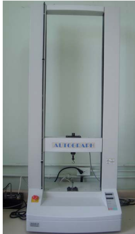
Fig 19. Máquina de pruebas universales (AGS-J Shimadzu Tokyo Japón).
