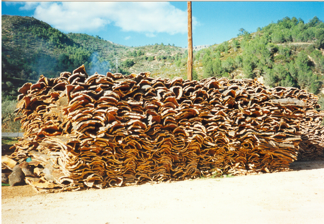
Planchas de corcho antes de hervir (Fuente: M. Pi)
