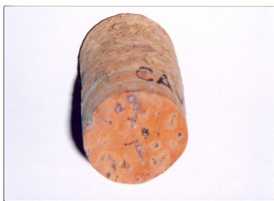
Contaminación fúngica en las arandelas
