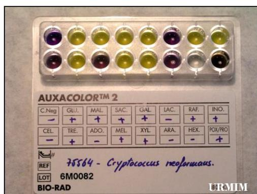
Figura 7: AUXACOLOR™2. Técnica comercial (BioRad®) para la identificación de levaduras, basada en el auxonograma, asimilación de azúcares. Germen identificado: *C. neoformans*.
