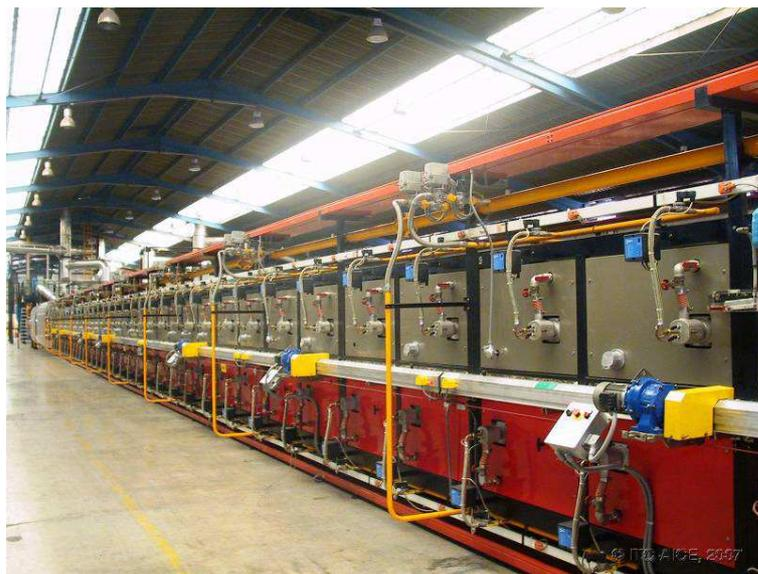
Figura 4.2. Horno industrial de cocción de baldosas cerámicas
