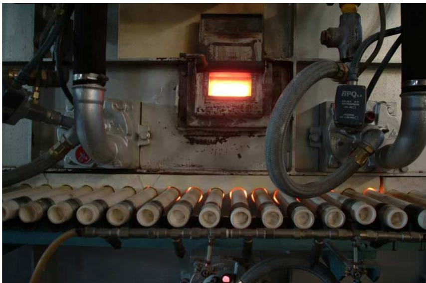
Figura 4.5. Mirilla en la zona de quemadores de un horno industrial.
