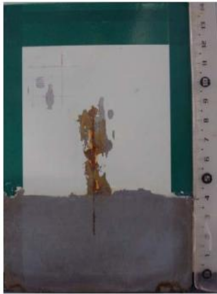
Figura 5.7. Aspecto superficial del panel de 30 micras formulado con pigmento anticorrosivo B al 6% (Réplica 5) después de 454 horas de cámara de niebla salina.
