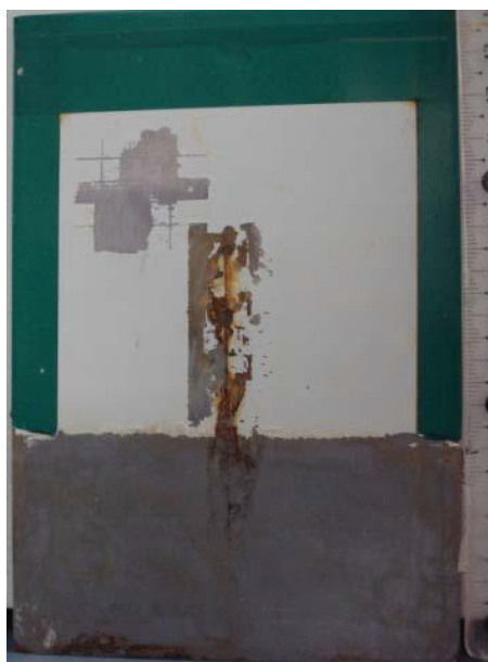
Figura 5.3. Aspecto superficial del panel de 30 micras formulado con pigmento anticorrosivo A al 4.5% (Réplica 4) después de 454 horas de cámara de niebla salina.
