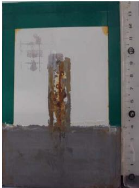
Figura 5.4. Aspecto superficial del panel de 30 micras formulado con pigmento anticorrosivo A al 6% (Réplica 5) después de 454 horas de cámara de niebla salina.
