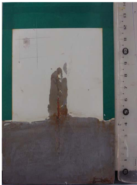
Figura 5.5. Aspecto superficial del panel de 30 micras formulado con pigmento anticorrosivo B al 3% (Réplica 5) después de 454 horas de cámara de niebla salina.
