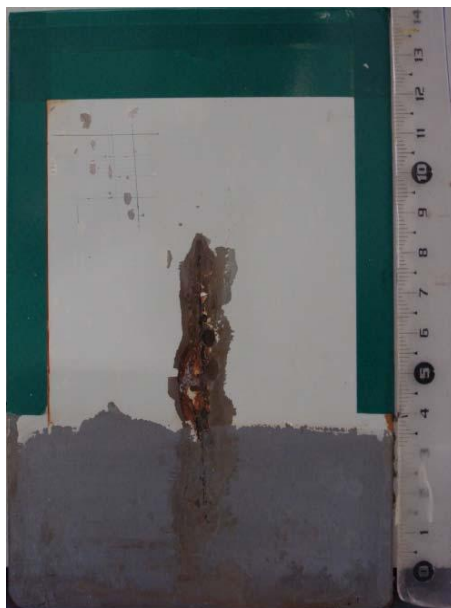
Figura 5.8. Aspecto superficial del panel de 30 micras formulado con pigmento anticorrosivo C al 3% (Réplica 5) después de 454 horas de cámara de niebla salina.
