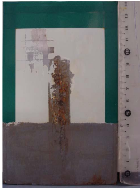
Figura 5.2. Aspecto superficial del panel de 30 micras formulado con pigmento anticorrosivo A al 3% (Réplica 5) después de 454 horas de cámara de niebla salina.
