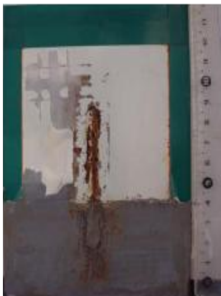
Figura 5.1. Aspecto superficial del panel de 30 micras formulado sin pigmento anticorrosivo (Réplica 5) después de 454 horas de cámara de niebla salina.
