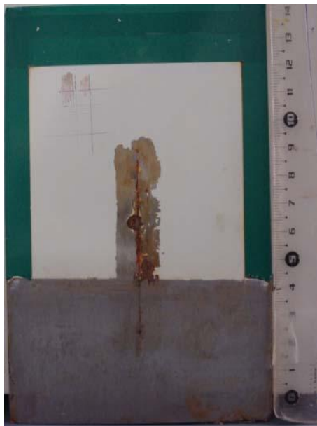
Figura 5.6. Aspecto superficial del panel de 30 micras formulado con pigmento anticorrosivo B al 4.5% (Réplica 6) después de 454 horas de cámara de niebla salina.
