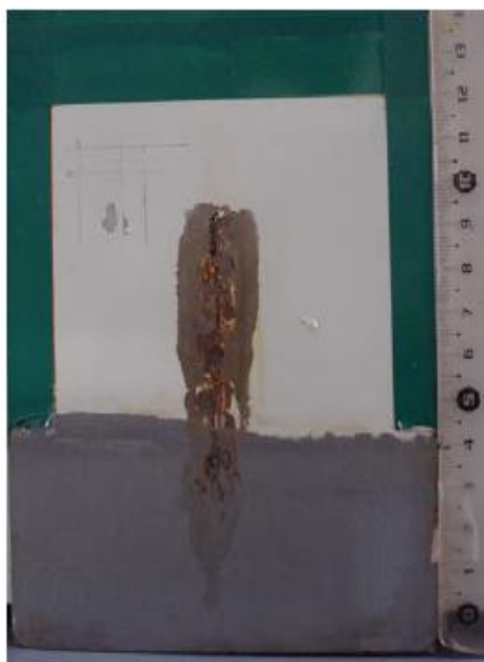
Figura 5.9. Aspecto superficial del panel de 30 micras formulado con pigmento anticorrosivo C al 4.5% (Réplica 5) después de 454 horas de cámara de niebla salina.
