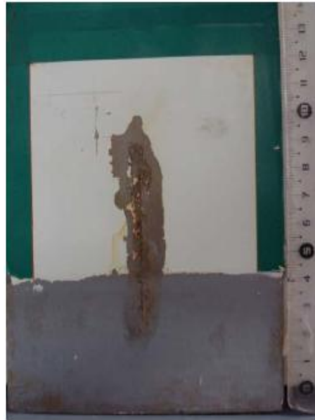
Figura 5.10. Aspecto superficial del panel de 30 micras formulado con pigmento anticorrosivo C al 6% (Réplica 5) después de 454 horas de cámara de niebla salina.
