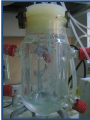
Figura 16. Sistema de perfusió salina. El cor era connectat a la cànula de perfusió a través de l'aorta ascendent. Per tal de mantenir la temperatura de l'òrgan es protegia amb un vas atemperat gràcies a un circuit d'aigua a temperatura controlada.
