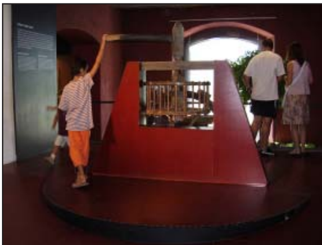
Figura 60. Maqueta interactiva del mecanisme d'extracció d'aigua d'una sínia andalusina.
