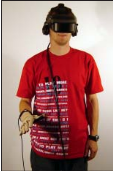
Figura 34. Equipament format per un casc amb visió estereoscòpica i uns guants tàctils per experimentar la realitat virtual immersiva (Foto: < http://www.fi.upm.es > [Consulta: 10/12/06]).
