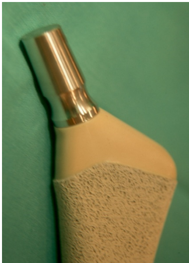
Fig 7: foto de prótesis tipo EPOCH, ejemplo de material compuesto de polímero y metal en la práctica clínica,
