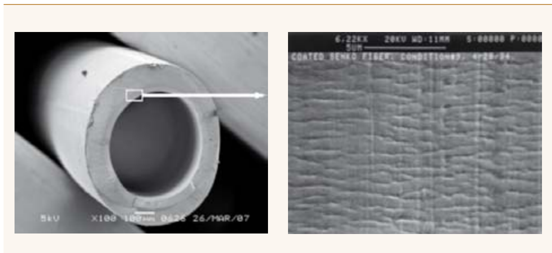
FIGURA 15. Imágenes de microscopía electrónica que muestran la configuración capilar (izquierda) y la membrana microporosa (derecha) que conforman los actuales oxigenadores (ampliación x6220).
