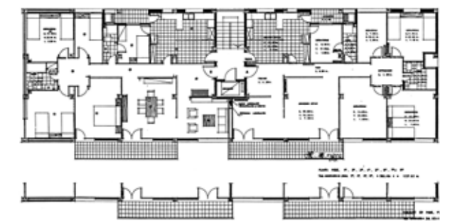
48 Planta tipus amb posició alterna de balcons en les plantes parells i senars
