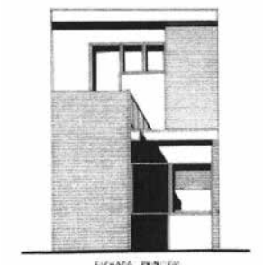
19 Alçat general d'una part del conjunt i d'un habitatge tallat per l'eix de simetria de la unitat formada per dues vivendes. Els plans d'obra ceràmica acaparen el protagonisme
