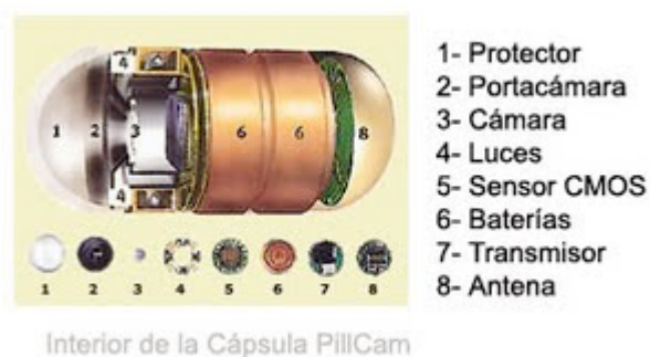
Figura 12. Cápsula endoscópica. Componentes.
