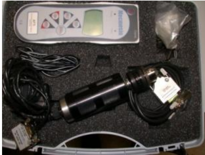
Figura 14.-Máquina Mecmesin para medir el torque de inserción y para medir el torque de fractura
