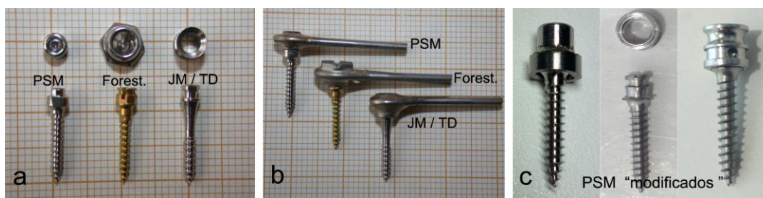
Figura 27.- (a) MIOs y sus correspondientes aditamentos antes de su colocación, (b) brazos anteriores con doble alambre “ uno al lado del otro” del DH de los 3 sistemas testados y (c) aditamentos del tornillo de PSM modificados con una versión alargada enroscada (foto de la izquierda) y una versión alargada cementada ( las 2 fotos de la derecha).
