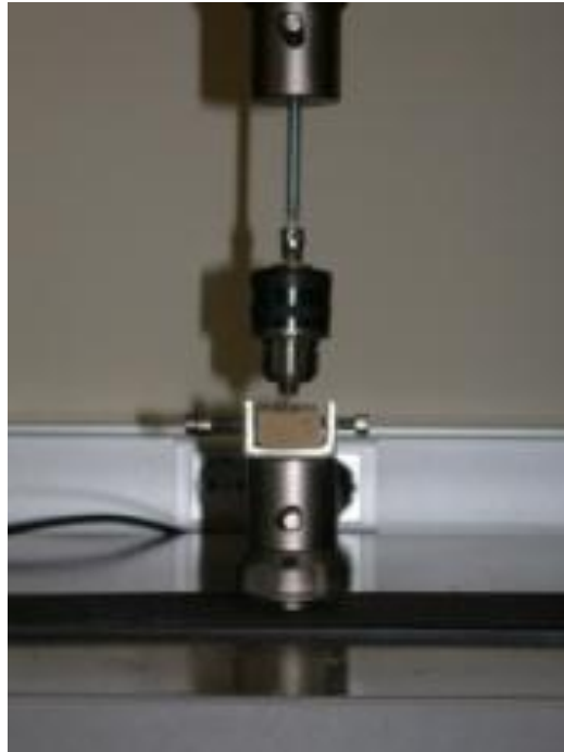
Figura 13.- Máquina universal Galdabini 1890 servo-hidráulica y mecanismo de agarre para realizar la fuerza de arrancado o de extracción de los MIOs colocados a 8mm de profundidad.
