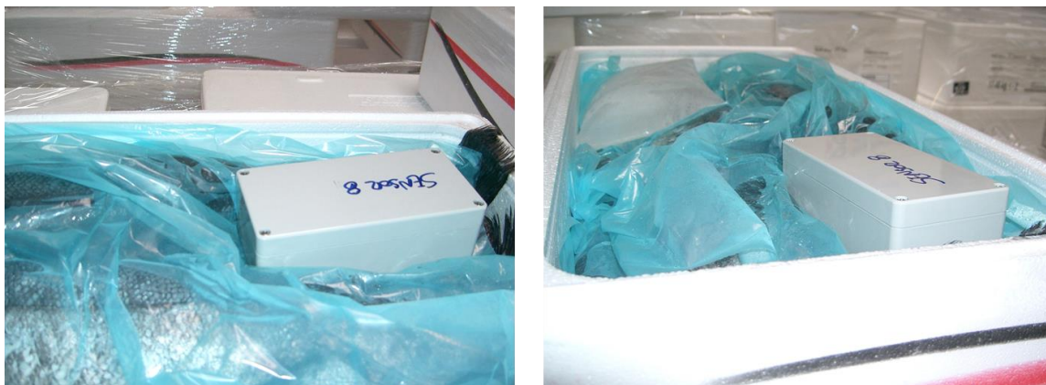
Figura 35: Posición de la tarjeta RFiD dentro de la caja de merluza.
