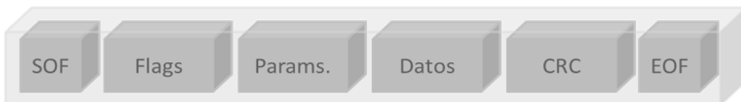
Figura 59: Formato de una trama de respuesta según la norma ISO/IEC 15693.
