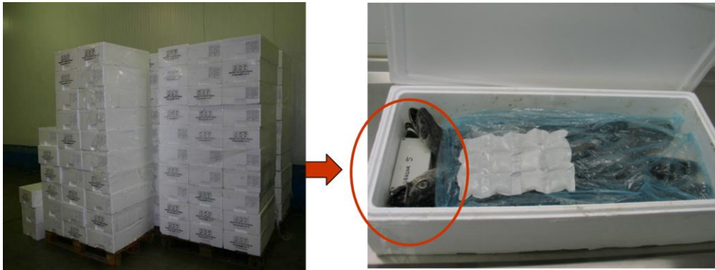
Figura 36: Apilamiento de cajas de merluza ya procesadas y clasificadas y colocación de los sensores dentro de las cajas de merluza.
