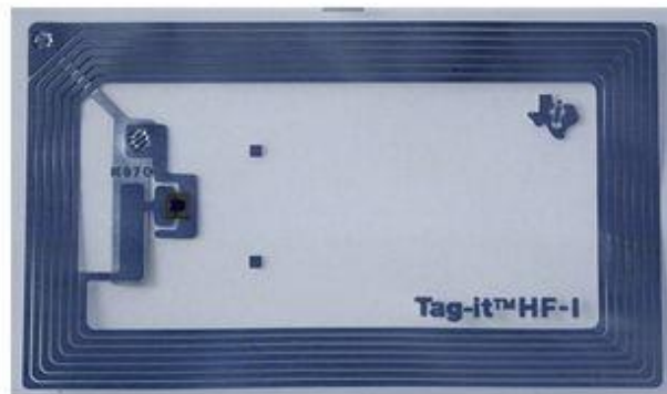
Figura 4: Tarjeta RFID HF con memoria programable de 2048 bits de la empresa Texas Instruments.
