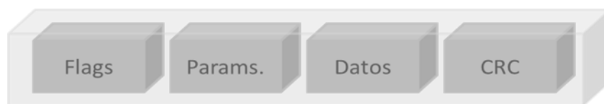
Figura 57: Formato de un mensaje de respuesta según la norma ISO/IEC 15693.
