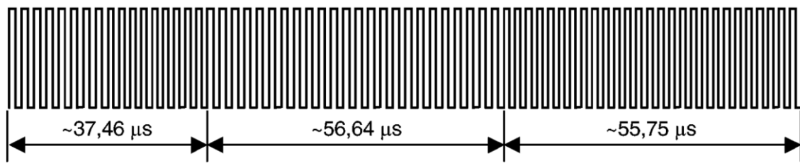
Figura 53: EOF de la comunicación VICC a VCD cuando se utilizan dos subportadoras.
