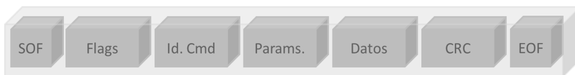
Figura 58: Formato de una trama de petición según la norma ISO/IEC 15693.
