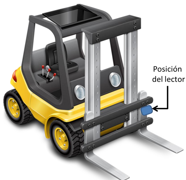
Figura 10: Posición del lector RFIID en la carretilla elevadora [10].
