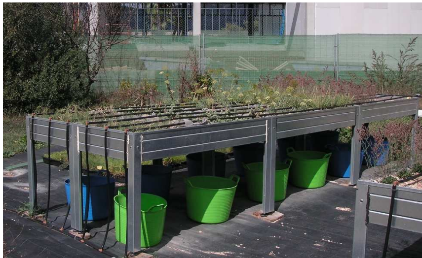
Figura 3.8 Recolección de agua drenada en los módulos experimentales - Experimento 2.
