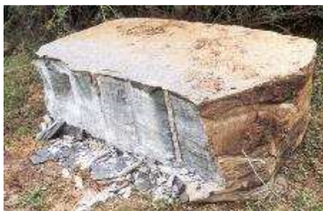
Figura 2. 12 – Roca rota mediante el uso de morteros expansivos (Fuente: cemento BROKE S.L.)
