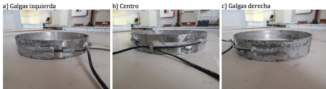
Figura 5.9 – Estado final del anillo metálico del Método del anillo
