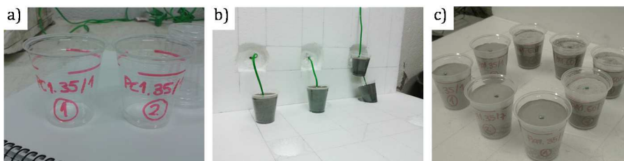
Figura 3. 9 – Portamuestras para ensayo de calorimetría isotérmica; a) Portamuestras con marca de aforo; b) final de ensayo a 48h; c) total de muestras ensayadas simultáneamente
