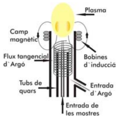
Figura 95: Esquema de la flama d'argó de l'atomitzador.
