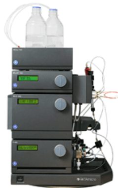
Figura 93: Equip de FPLC utilitzat per a la purificació de proteïnes.
