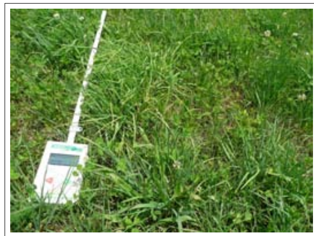
Figura 44: Ceptòmetre emprat en la mesura de la PAR.
