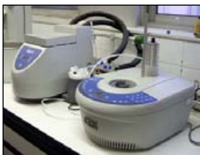
Figura 64. Reactor de Microones emprat en la reacció de Sonogashira catalitzada per 3b-Pd NP .
