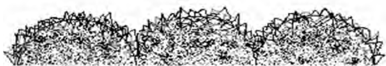
Figura 2.29: Esquema de la superficie mostrando la superficie de aglomerados semiesféricos formados por los cristales de apatita.
