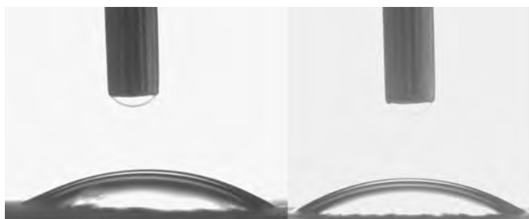
Figura 2.27: Ángulo de Contacto mediante el método de los dos líquidos. Imagen izquierda: TP Grueso. Imagen Derecha: TP Fino
