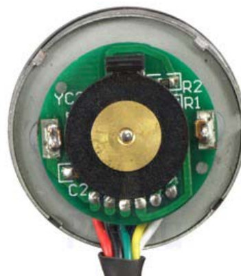
Fig. 3.1. Ejemplos de aplicaciones de codificadores rotativos incrementales: a) Hokuyo URG-04LX-UG01 Laser Rangefinder; b) Rueda de desplazamiento de un ratón informático; c) Codificador rotativo magnético aplicado en el eje de un motor DC.
