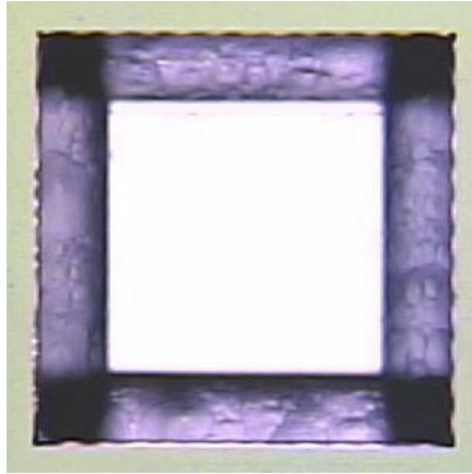
Figura 2.4: Pareds del gravat anisòtrop per una obertura quadrada.
