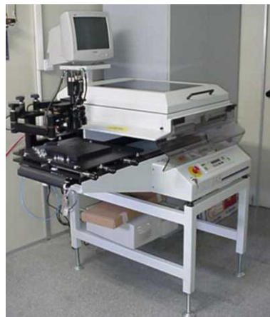
Figura 4.9: Equip pel dipòsit de pasta de soldadura amb la tècnica screen-printing.
