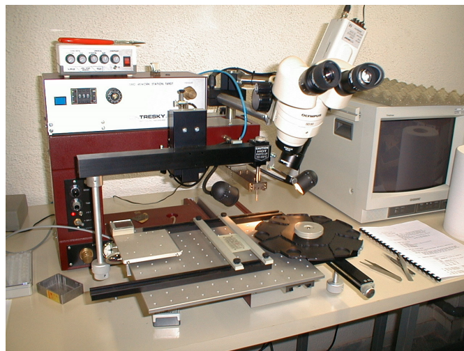
Figura 4.10: SMD Rework Station pel muntatge dels mòduls multixip.
