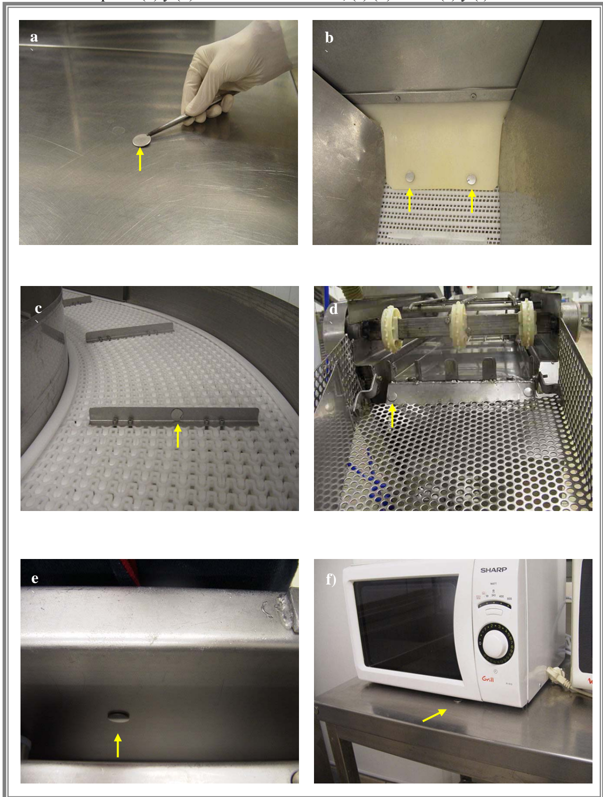
Figura 9. Las imágenes ilustran la colocación de los discos de acero inoxidable de forma aséptica. (a) y (b): elaboración-ensasado, (c) (d): carne (e) y (f): cocina.
