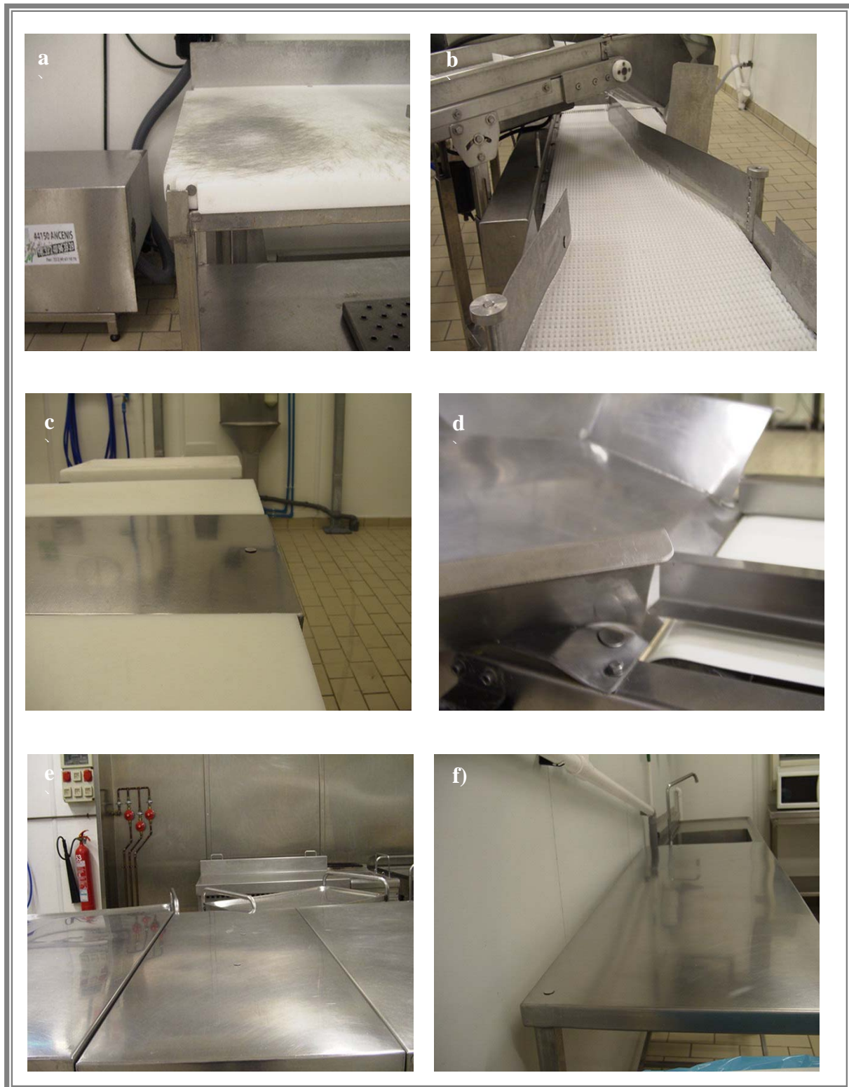
Figura 8 (a) y (b): mesa de manipulación de polietileno liso y la cinta de alineación de polietileno articulada ubicadas en la zona de elaboración y envasado; (c) y (d): mesas de despiece de polietileno liso y acero inoxidable y a la cinta ULMA de polietileno liso ubicadas en la zona de carne; (e) y (f) mesas de emplatado de acero inoxidable la mesa de preparación de ingredientes de acero inoxidable ubicadas en la zona de la cocina.
