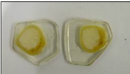
b. Tras el procesamiento de los cortes, se obtienen las muestras incluidas en el metacrilato
