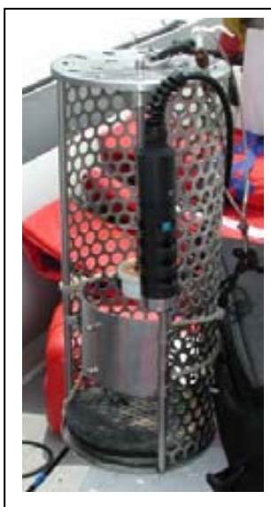
Figura 2.5. Detall de l'aparell de recollida de les mostres on es pot veure l'acoblament amb la sonda multiparamètrica YSI 556 MPS.
