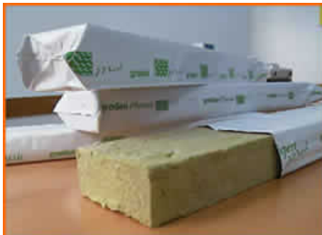
Fotografía 21: tablas de lana de roca (Rock wool)
