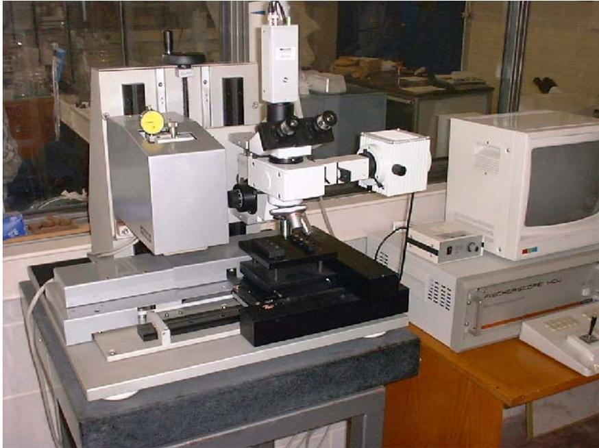
*Figura 2-59: Ultra-microdurómetro Fischerscope H100*
