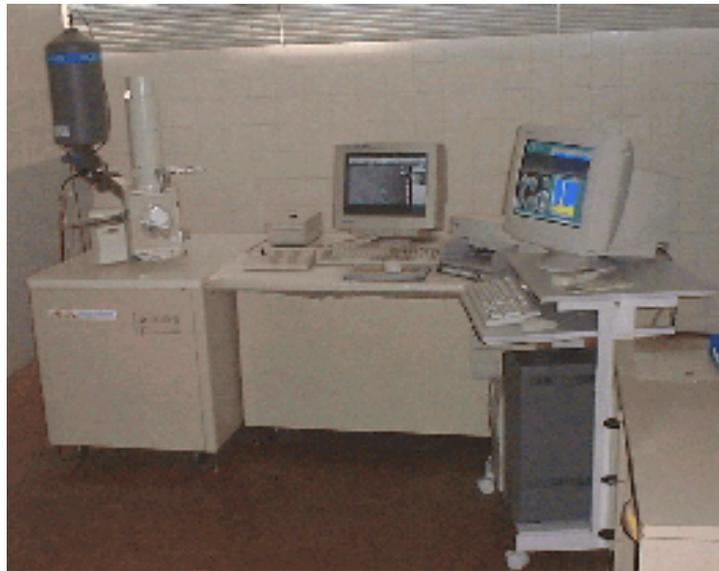
*Figura 2.1: Microscopio electrónico de barrido (SEM)*
