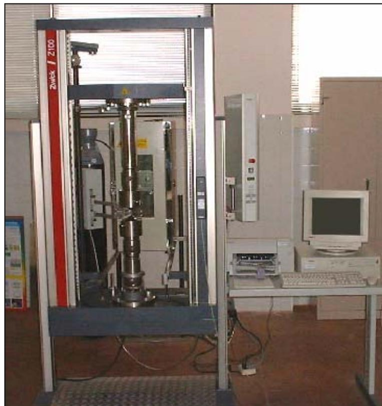
*Figura 2-38: Máquina de tracción Zwick Z100*
