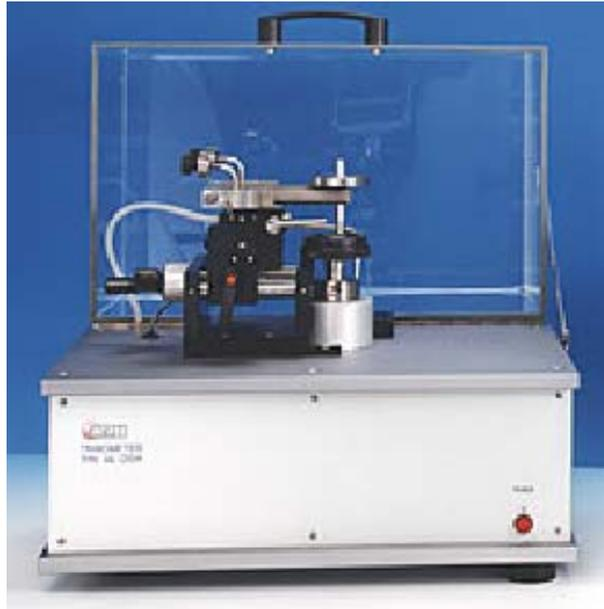
Figura 2-64: Tribómetro Pino n Disc
