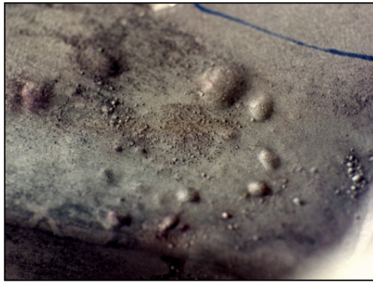
Figura 6.48. Ampollas en un semicomponente A356 T6.
