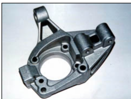
Figura 7.13. Rótula de dirección de automóvil de aleación A357, conformada por Thixocasting.
