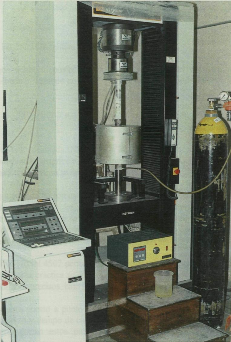
*Figura 7.2. Montaje del equipo de ensayo de compresión uniaxial puesto a punto en la UPC.*
