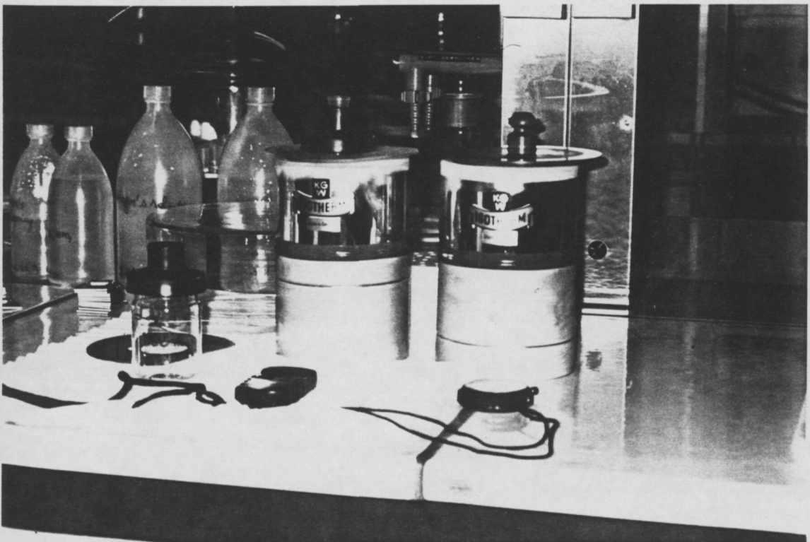
Figura 2.2.- Congelación de las muestras de cemento en nitrógeno líquido.
