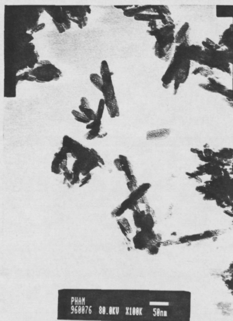
Figura 4.6.- Morfología de la hidroxiapatita precipitada que se añadió en un 2% en peso, para que actuara como semilla.
