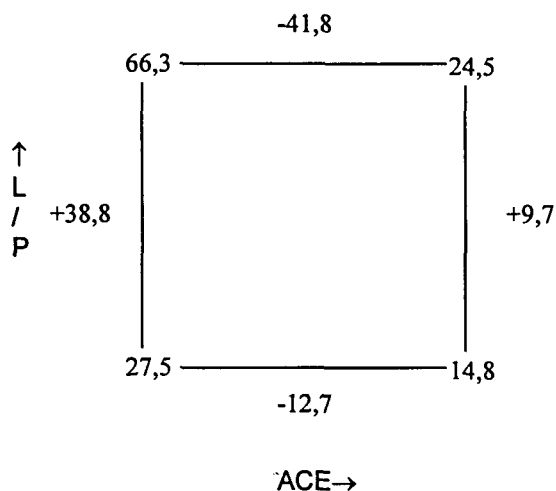
Figura 3.7.- Tabla de doble entrada que pone de manifiesto la interacción existente entre la relación L/P y el acelerante en la respuesta obtenida para el tiempo final de fraguado del cemento.
