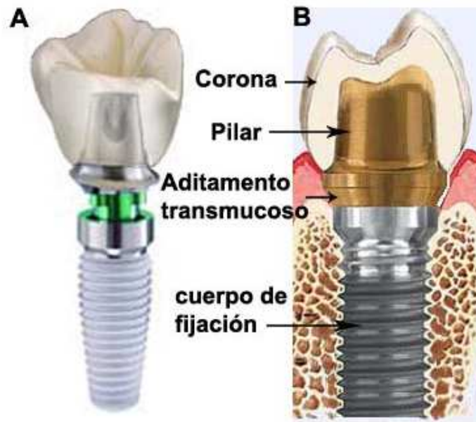
Figura 1.1. Implante dental de Titanio (A) y una esquematización de la interacción de las partes que lo componen con los tejidos circundantes (B).
