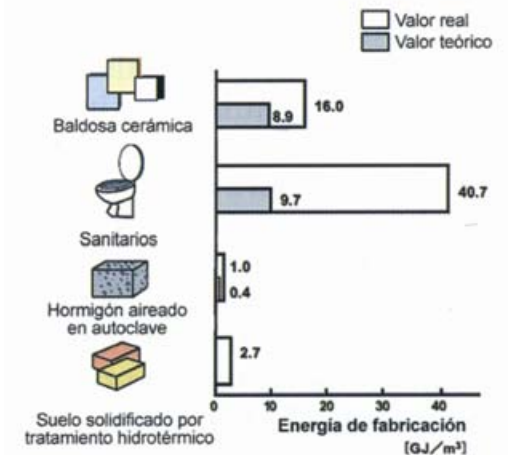
La cerámica de la tierra según Emile Ishida, de Inax Corporation Japan. Recuperación de técnicas tradicionales para obtener productos menos intensivos en energía y ajustados a las calidades efectivas que el uso les exigirá. Publicado en las actas del congreso Qualicer de 2004.
