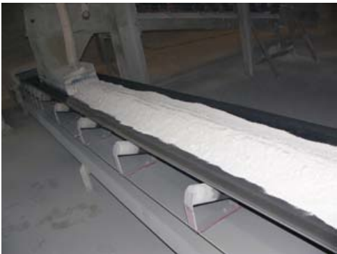
Línea de alimentación de arcilla (caolita) proveniente de importación en una fábrica de gres porcelánico en Castellón.
