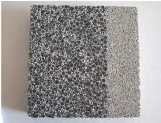
Panel de aislamiento térmico con árido de arcilla expandida Liapor en distintas dosificaciones.
