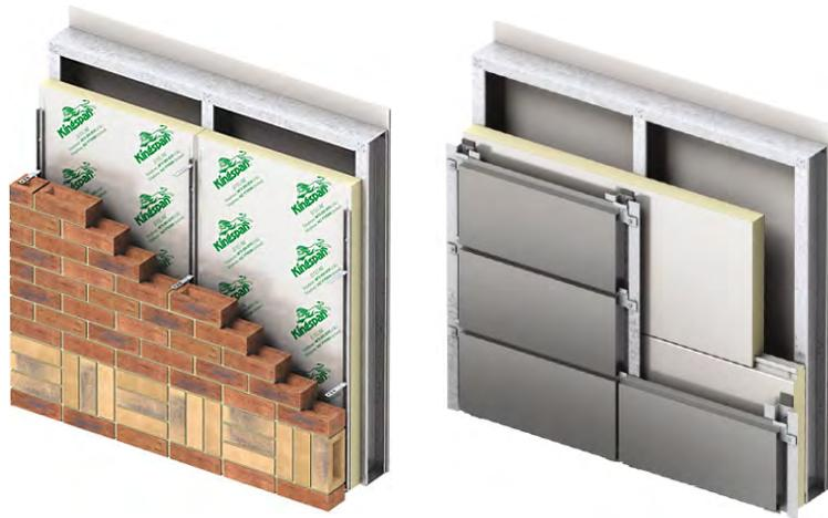
En este sistema, la estanqueidad al aire queda resuelta con el sellado entre las placas de aislamiento térmico por su cara exterior.
