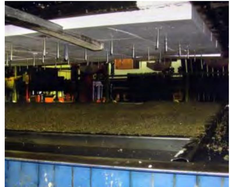
Proceso de fabricación de un panel sándwich con conectores puntuales Thermomass.
