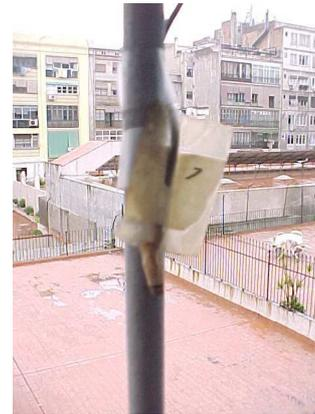
*Foto 2: Ubicación de la sonda de la temperatura exterior*
