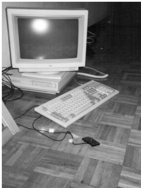
*Figura 2.: Sensores y ordenador que constituyen el sistema de adquisición de datos. En primer plano, célula fotovoltaica (oscura) y, unos 5 cm a su izquierda, sensor de temperatura con radiador.*
