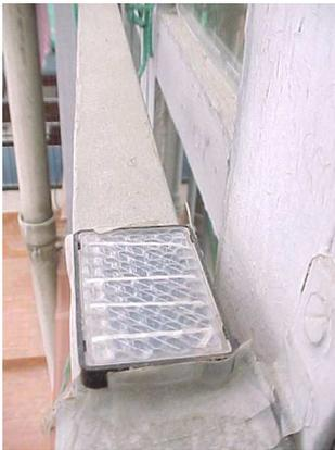
*Foto 1: Colocación de la célula fotovoltaica para la captación de la radiación solar*
