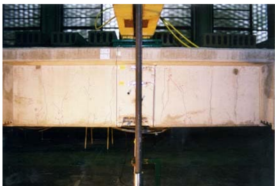
Fotografía 4.29 Deformada de la viga en un momento del ensayo VHA1_a
