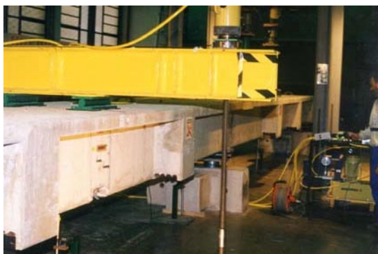
Fotografía 4.29 Deformada de la viga en un momento del ensayo VHA1_a
