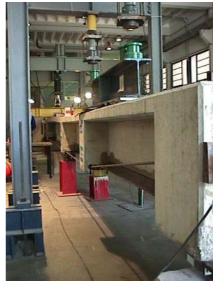
Fotografía 4.55a Vista general de la preparación del modelo. Puede verse el trazado del pretensado exterior.
