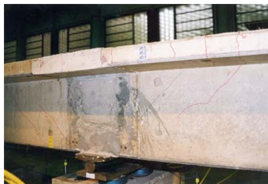
Fotografía 4.30 Fisuración de la viga en zona de máximo momento negativo
