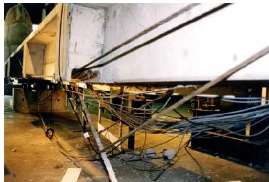
Fotografía 4.26 Vista del cordón roto durante el ensayo
