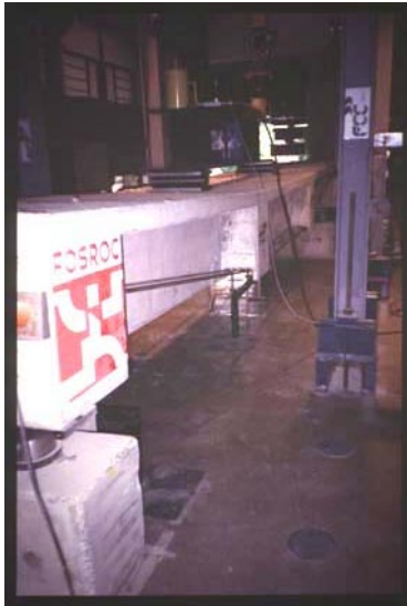
Fotografía 4.7 Deformada de la viga durante el ensayo VPE_1
