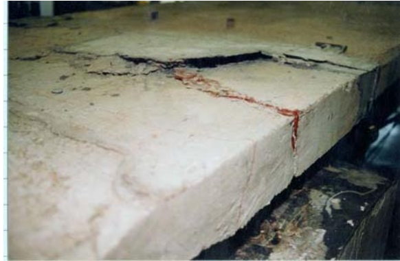
Fotografía 4.12 Aspecto de la fisuración en sección de apoyo Intermedio
