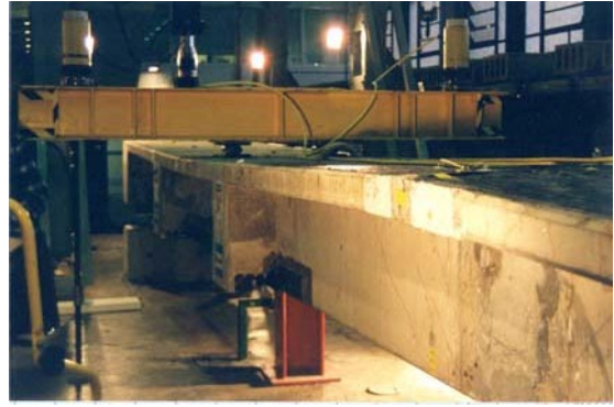
Fotografía 4.45 Vista general de la deformada de la viga después del ensayo.
