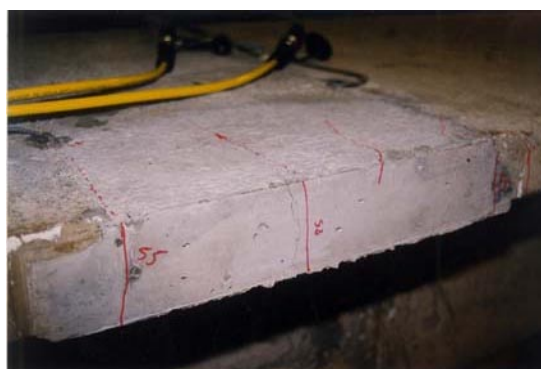
Fotografía 4.30 Fisuración de la viga en zona de máximo momento negativo
