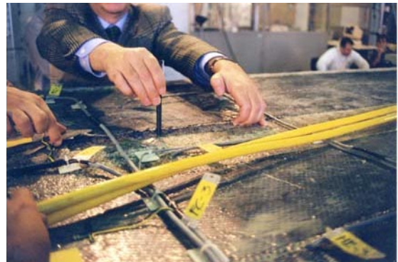
Fotografía 4.40 Vista de la rotura de la fibra de carbono.
